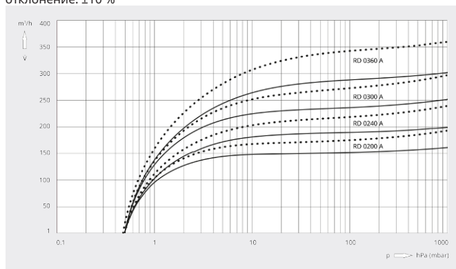
Скорость откачки Воздух при 20 °С. Допустимое отклонение: ±10 %
