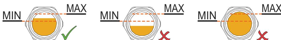
O nível de óleo deverá permanecer constante ao longo do tempo de vida útil do óleo. Se o nível diminuir, isto aponta para uma fuga e a máquina necessita de reparação.
