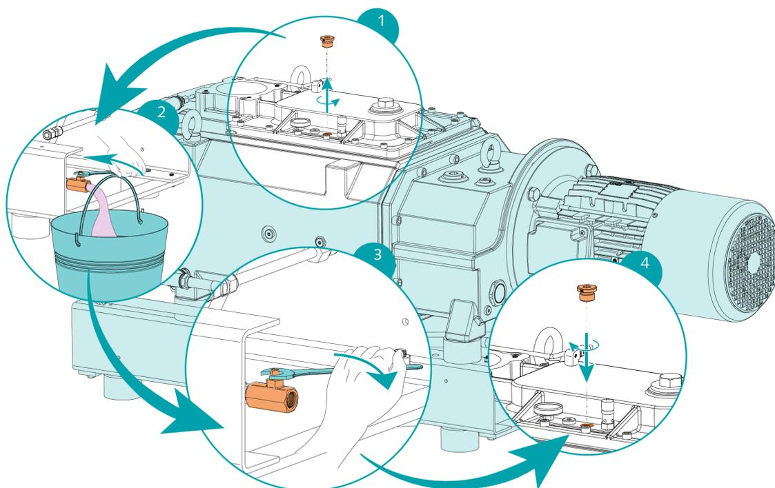
Relativamente ao tipo do líquido de refrigeração e à capacidade do líquido de refrigeração, consulte os Dados Técnicos e *Líquido de refrigeração* [→ 46].
