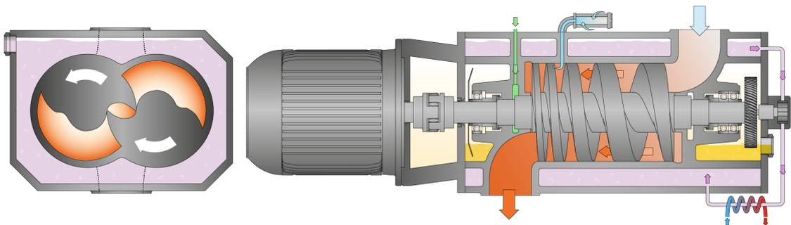
A máquina funciona segundo o princípio de bomba monocelular de parafuso duplo.
