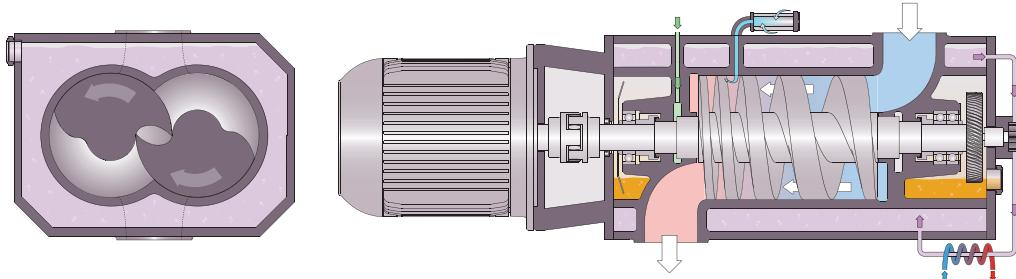
A máquina funciona segundo o princípio de bomba monocelular de parafuso duplo.
