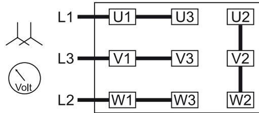
Conexão em estrela, motor multitensão (alta tensão):
