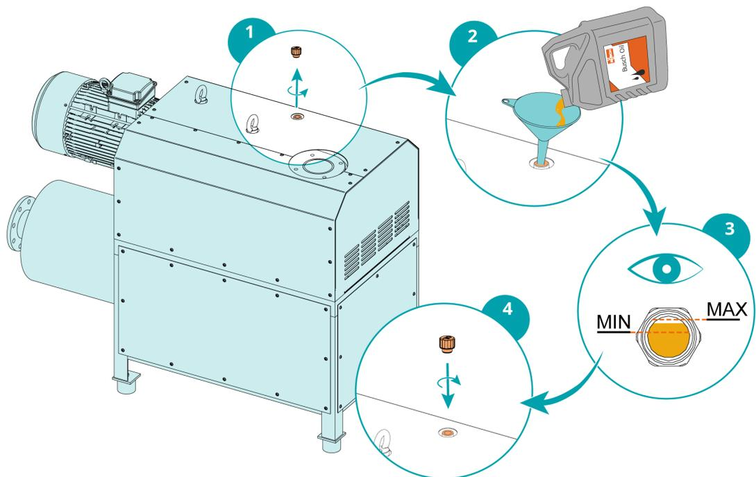
El nivel de aceite debe mantenerse constante durante su vida útil. Si desciende, esto indica una fuga y la máquina necesitará reparación.
