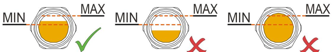
El nivel de aceite debe mantenerse constante durante su vida útil. Si desciende, esto indica una fuga y la máquina necesitará reparación.
