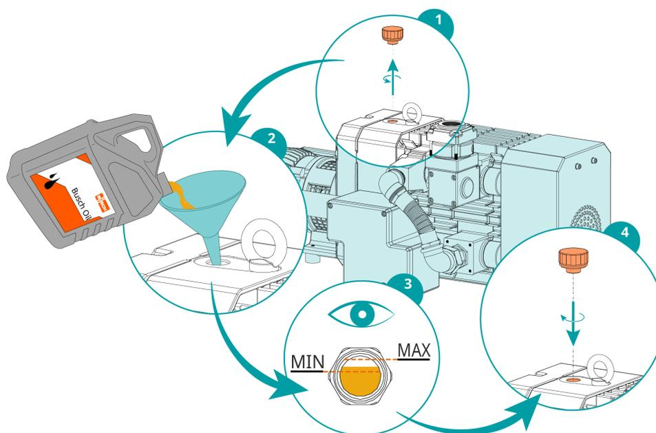
Oljenivået skal holdes konstant under oljens levetid. Hvis nivået faller, indikerer det en lekkasje og maskin må repareres.
