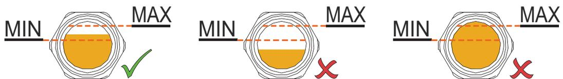
Oljenivået skal holdes konstant under oljens levetid. Hvis nivået faller, indikerer det en lekkasje og maskin må repareres.
