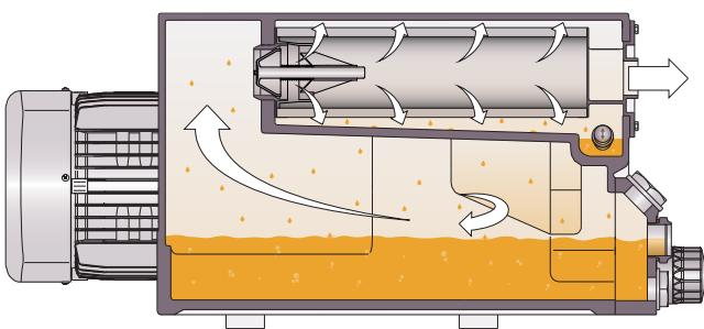
Maskinen styres av roterende lameller.
