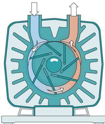
Maskinen styres av roterende lameller.
