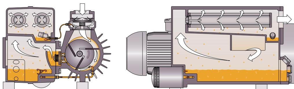
Maskinen styres av roterende lameller.
