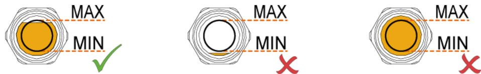
Füllen Sie bei Bedarf Öl nach.
