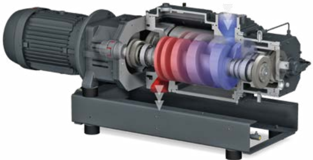
Fig. 7: Trockene Schrauben-Vakuumpumpe COBRA NX von Busch Vacuum Solutions
