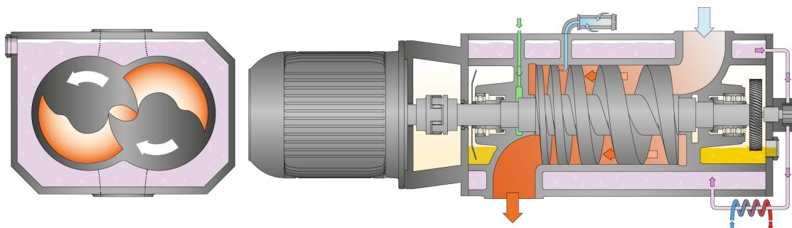
この機械は、1段式のツインスクリューポンプ原理で動作します。
