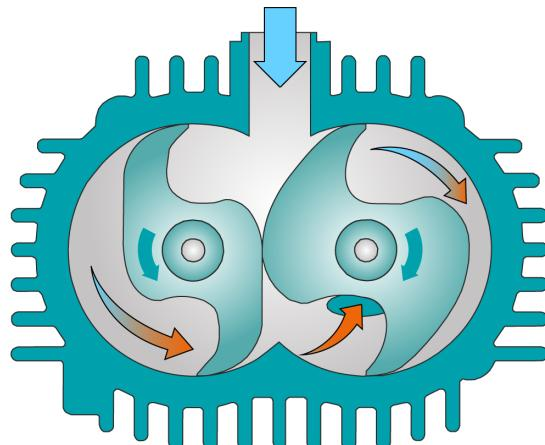
この機械は、クロ一原理で動作します。
