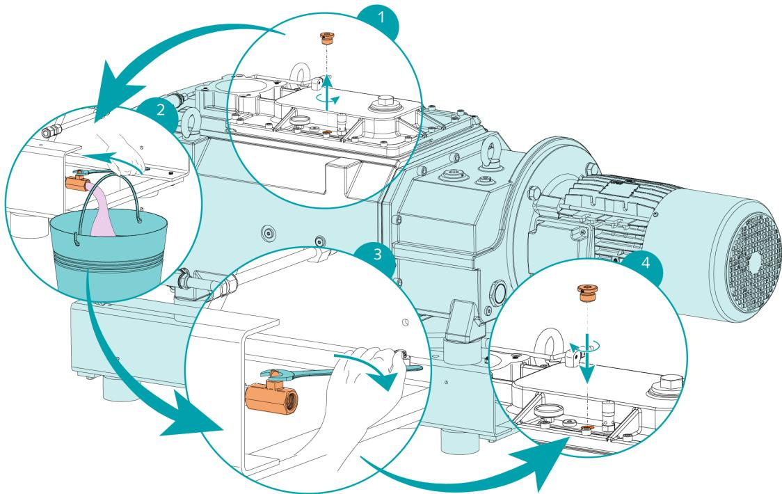
冷却液のタイプおよび冷却液容量については、「テクニカルデータ」および「冷却液[→ 45]」を参照してください。
