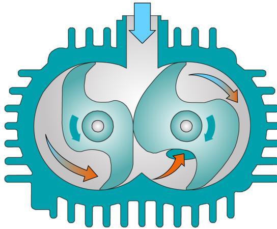
この機械は、クロー原理で動作します。
