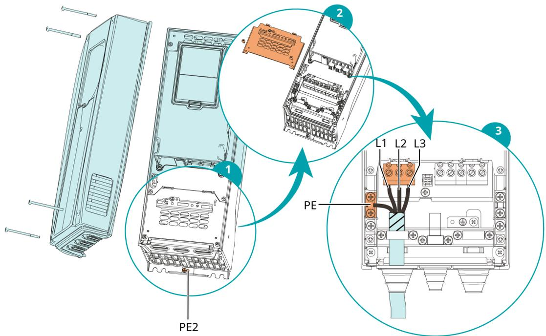
リーク電流は3.5 mA (AC) を超えます。EN 61800-5-1に従い、追加の保護アースコンダクター（PE2）を接続してください。
