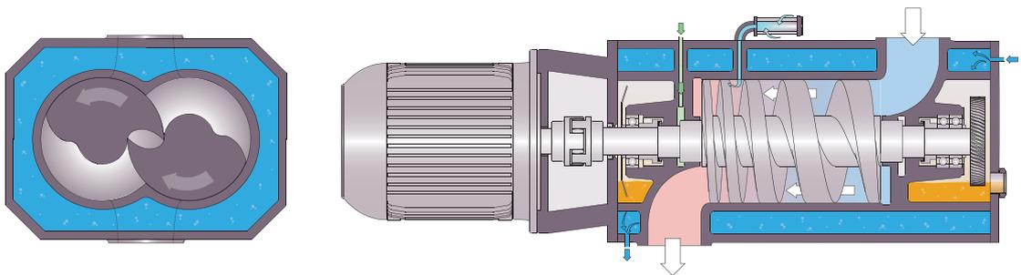
この機械は、1段式のツインスクリーンプンプ原理で動作します。
