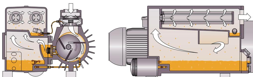
この機械は、ロータリーベーン原理で動作します。
