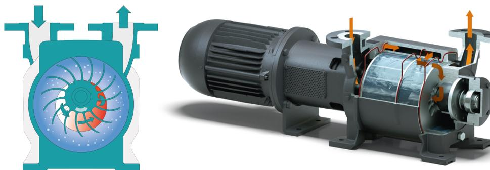
この機械は、水封原理で動作します。
