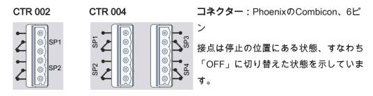
プロセスの管理のため、このデバイスの出力は2つ、もしくはそれぞれ4つのリレースイッチ(切り替えタイプ)SP1からSP4での切り替え機能をもたらします。切り替え出力はいずれかの測定チャネルに割り当てられ、主導にてON/OFFを切り替えることができます。
