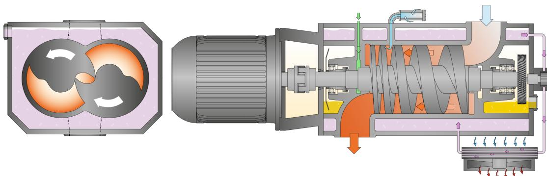
この機械は、1段式のツインスクリューポンプ原理で動作します。
