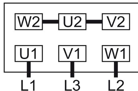
Collegamento a doppia stella, motore a multitemperatura con 9 pin (bassa tensione):
