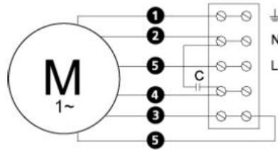
C = condensatore permanente
