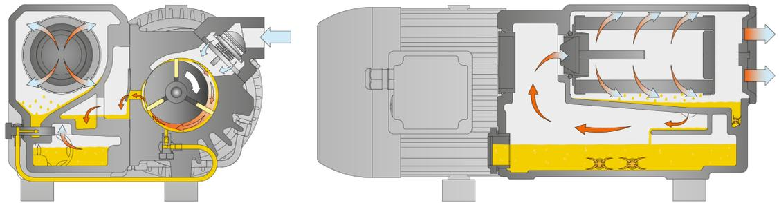
Die Maschine funktioniert nach dem Drehschieberprinzip.
