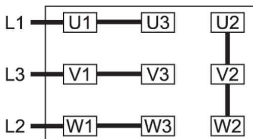
Connexion en étoile, moteur multi-tension à 9 broches (haute tension) :
