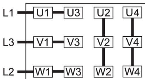
Connexion en étoile, moteur multi-tension à 12 broches (haute tension) :V
