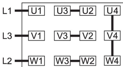
Connexion en triangle, moteur multi-tension à 12 broches (moyenne tension) :
