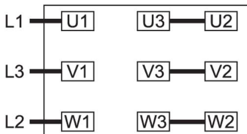
Connexion en étoile double, moteur multi-tension à 12 broches (basse tension) :
