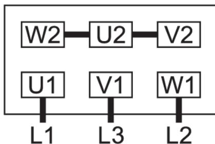
Connexion en étoile double, moteur multi-tension à 9 broches (basse tension) :
