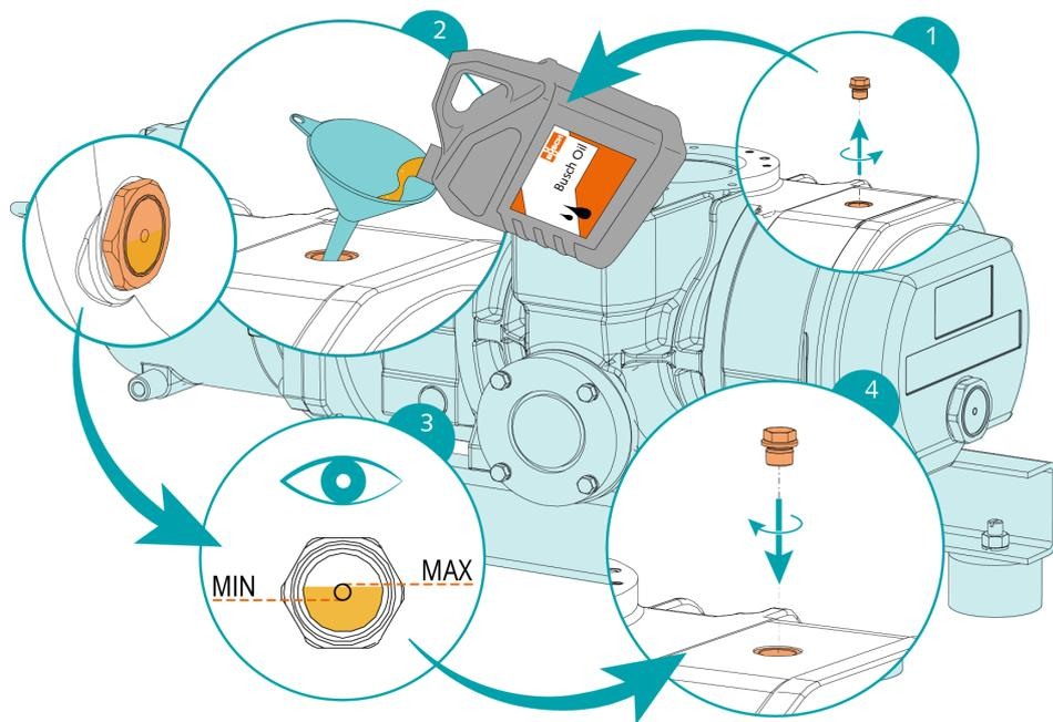
Nach dem Befüllen mit Öl:
