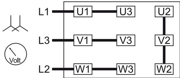
Sternschaltung, Multispannungsmotor mit 9 Klemmen (hohe Spannung):
