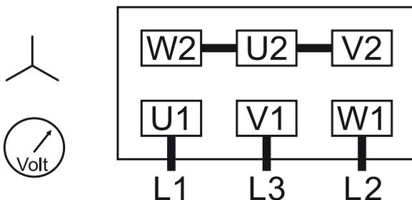
Doppel-Sternschaltung, Multispannungsmotor mit 9 Klemmen (niedrige Spannung):
