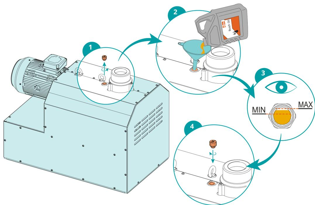
Le niveau d'huile doit rester constant pendant toute la durée de vie de l'huile. Une baisse du niveau indique une fuite et la machine doit être réparée.
