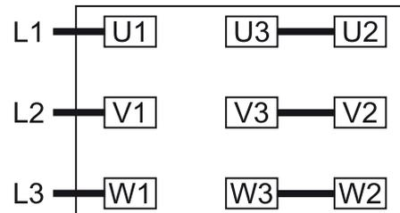
Connexion en étoile double, moteur multi-tension à 12 pôles (basse tension) :
