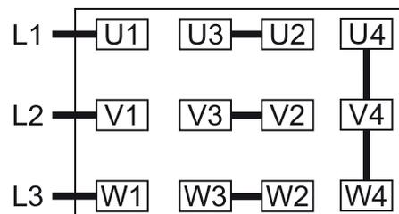
Connexion en triangle, moteur multi-tension à
