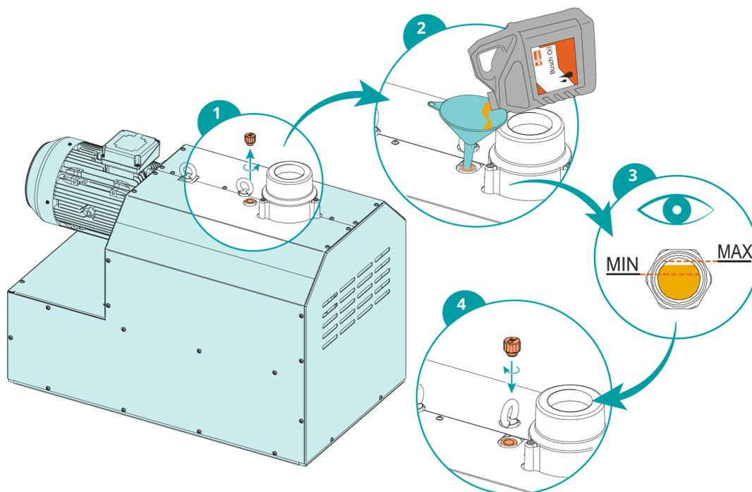
Le niveau d'huile doit rester constant pendant toute la durée de vie de l'huile. Une baisse du niveau indique une fuite et la machine doit être réparée.
