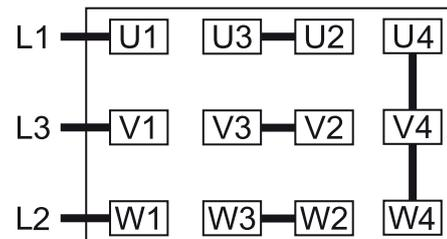
Connexion en triangle, moteur multi-tension à 12 pôles (moyenne tension) :
