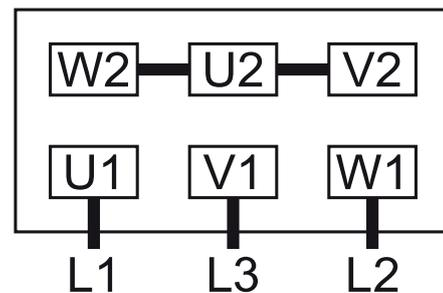
Connexion en étoile double, moteur multi-tension à 12 pôles (basse tension) :
