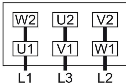
Connexion en étoile (haute tension) :
