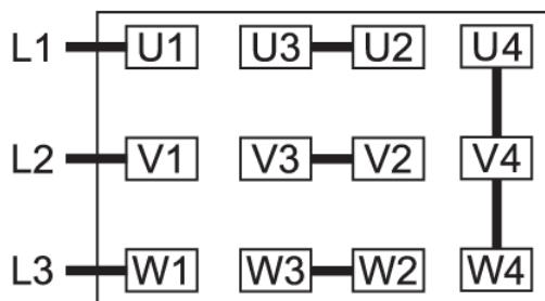
Deltaforbindelse, multispændingsmotor med 12 ben (mellemværdi):
