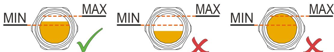
Oliestanden skal forblive konstant i løbet af oliens levetid. Hvis niveauet falder, indikerer dette en lækkage, og maskine kræver reparation.
