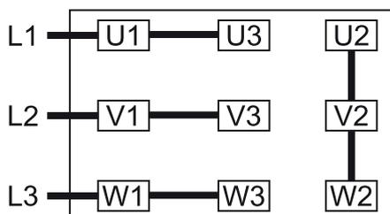
Stjerneforbindelse, multispændingsmotor med 9 ben (højspænding):
