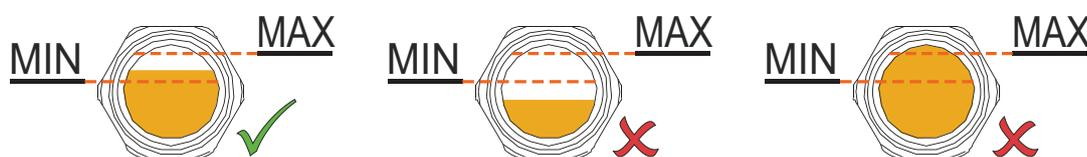
Oliestanden skal forblive konstant i løbet af oliens levetid. Hvis niveauet falder, indikerer dette en lækage, og maskine kræver reparation.
