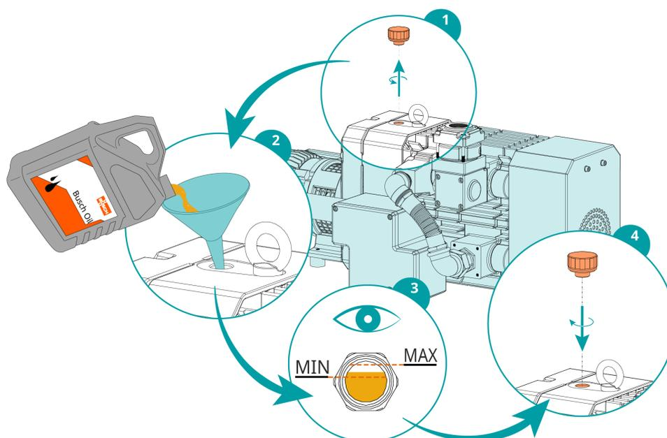
Oliestanden skal forblive konstant i løbet af oliens levetid. Hvis niveauet falder, indikerer dette en lækage, og maskine kræver reparation.
