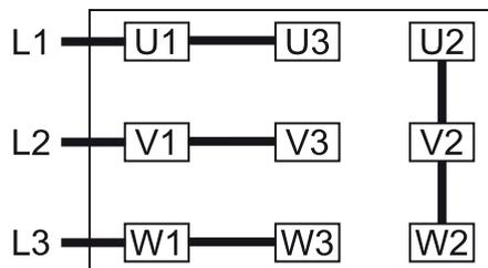
Stjerneforbindelse, multispændingsmotor med 9 ben (højspænding):
