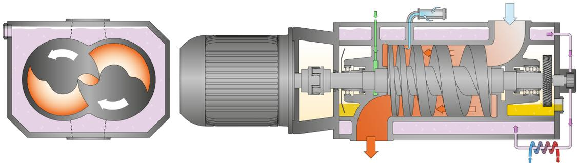
Die Maschine funktioniert nach dem einstufigen Doppelschrauben-Pumpprinzip.
