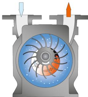
Die Maschine funktioniert nach dem Flüssigkeitsringprinzip.
