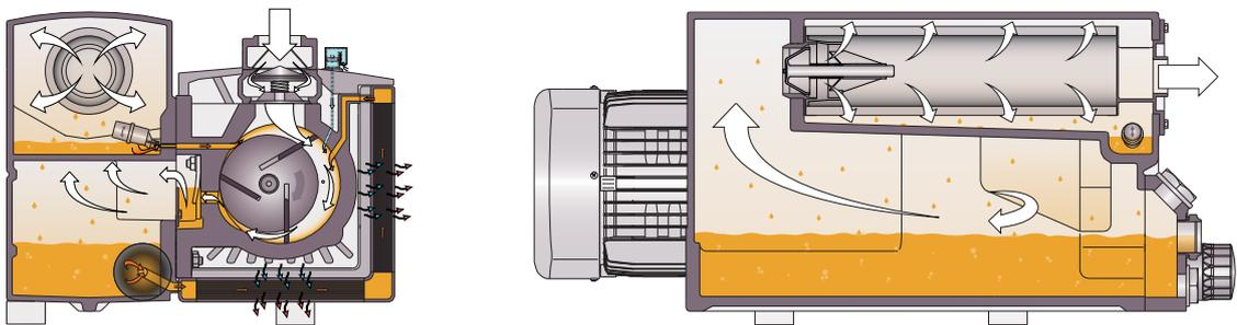
Die Maschine funktioniert nach dem Drehschieberprinzip.
