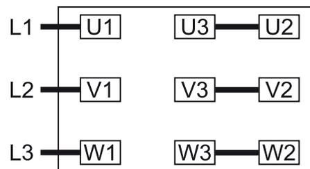
Doppelstern-Schaltung, Mehrspannungsmotor mit 12 Pins (Niederspannung):
