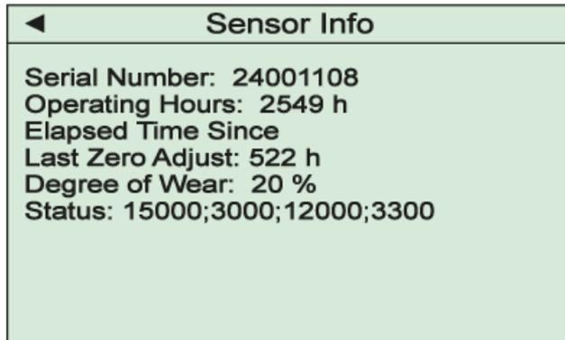
En este elemento del menú se muestra información relativa al sensor de su dispositivo, por ejemplo, parámetros que le ayudarán a estimar el grado de desgaste.
