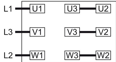
Conexión en doble estrella, motor multivoltaje con 12 pines (baja tensión):
