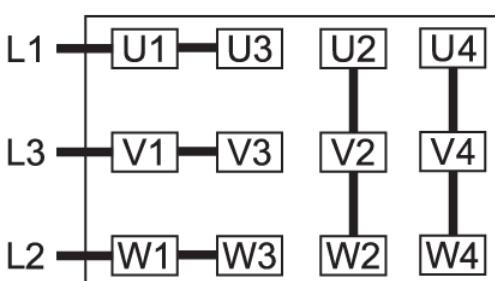
星形连接，多电压电机，含 12 针（高电压）：
