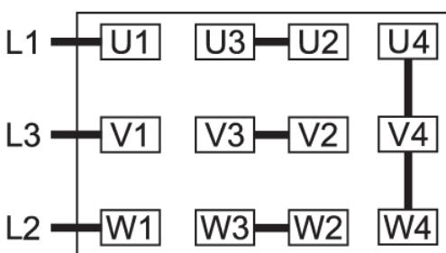
三角形连接，多电压电机，含 12 针（中电压）：
