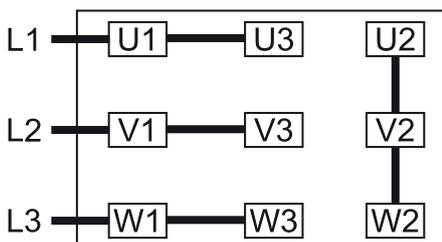
星形连接, 多电压电机, 含 9 针 (高电压):
