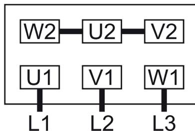
双星形连接, 多电压电机, 含 9 针 (低电压):
