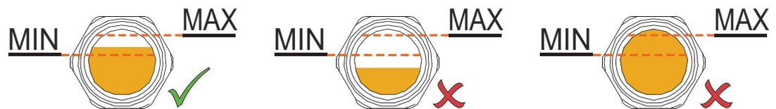
油位应在油的使用寿命内保持恒定。如果液位确实下降了，这说明机器出现了泄漏，需要维修。
