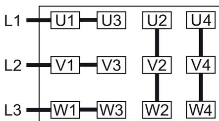
星形连接, 多电压电机, 含 12 针 (高电压):
