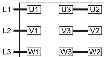
双星形连接, 多电压电机, 含 12 针 (低电压):
