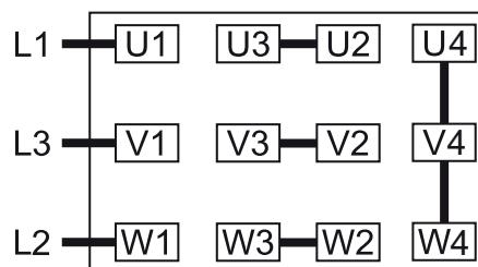
三角形连接，多电压电机，含 12 针（中电压）：
