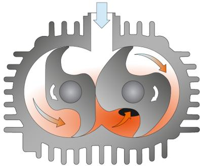
La macchina funziona in base al principio delle camme.
