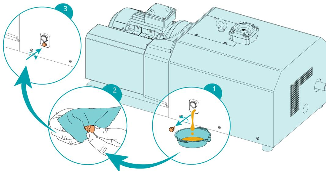
Per il tipo e la capacità dell'olio, vedere *Dati tecnici* [→ 35] e *Olio* [→ 37].
