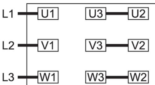
Collegamento a doppia stella, motore multi-tensione con 12 pin (bassa tensione):
