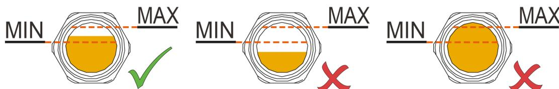
Das Ölniveau sollte über die gesamte Lebensdauer des Öls konstant bleiben. Wenn das Niveau sinkt, ist es ein Anzeichen von Undichtigkeit und die Maschine muss repariert werden.
