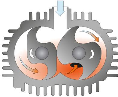
Die Maschine funktioniert nach dem Klauenprinzip.
