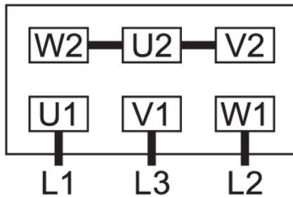
Collegamento a doppia stella, motore multi-tensione con 12 pin (bassa tensione):
