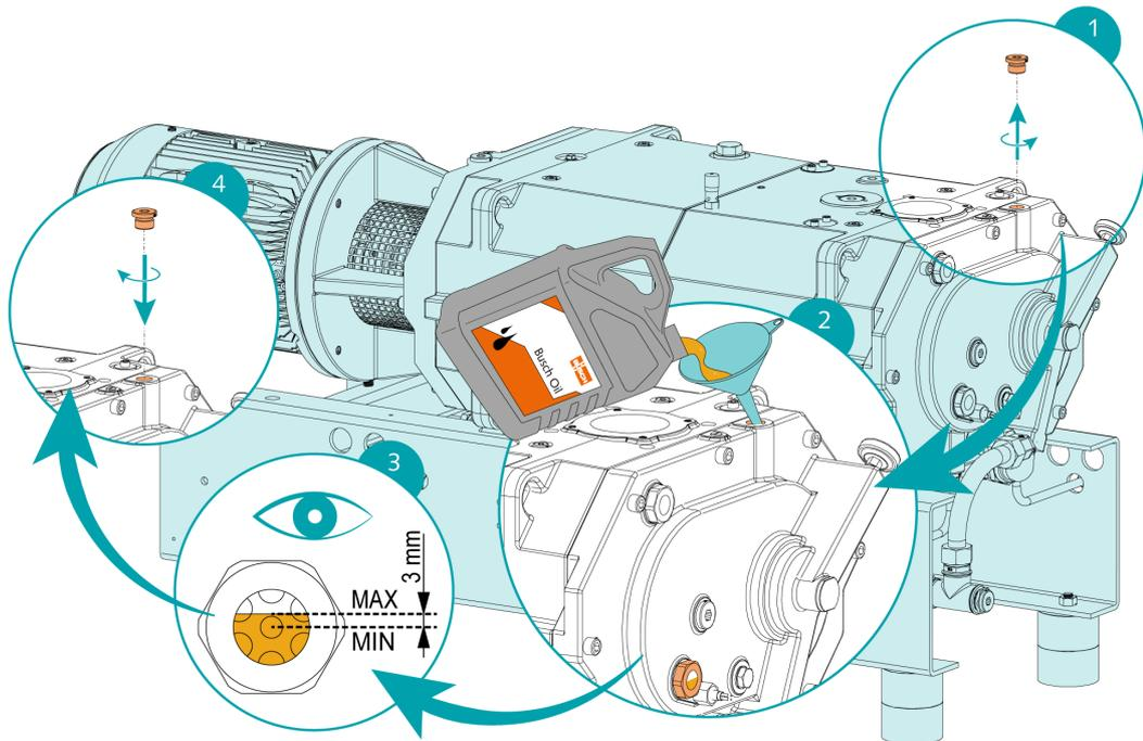
Una volta effettuato il rifornimento dell'olio:
