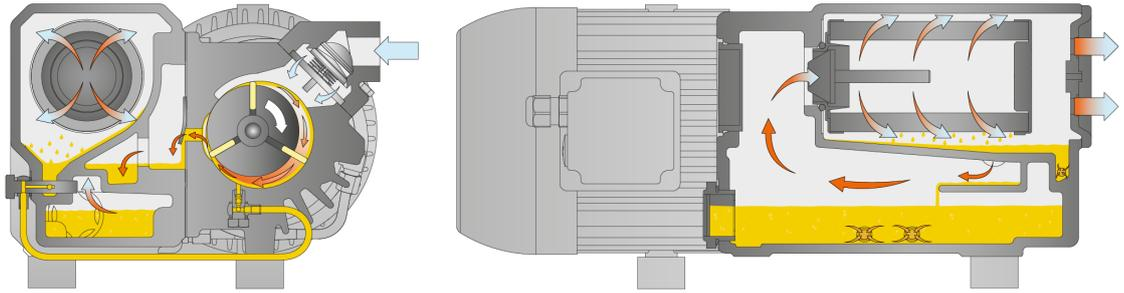
Die Maschine funktioniert nach dem Drehschieberprinzip.
