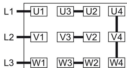
Connexion en triangle, moteur multi-tension à
