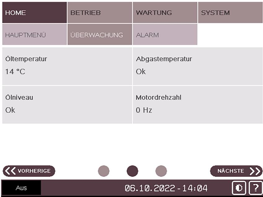
**Öltemperatur:** Gibt die Öltemperatur wieder, bei einer zu hohen Temperatur wird eine Warn- oder Alarmmeldung ausgegeben, siehe *Fehlfunktion* [→ 53].
