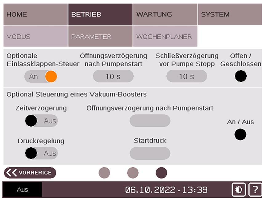
Das System ermöglicht eine Zeitverzögerung zwischen dem Öffnen des Ventils und dem Start der Vakuumpumpe (Standardwert 10 s).
