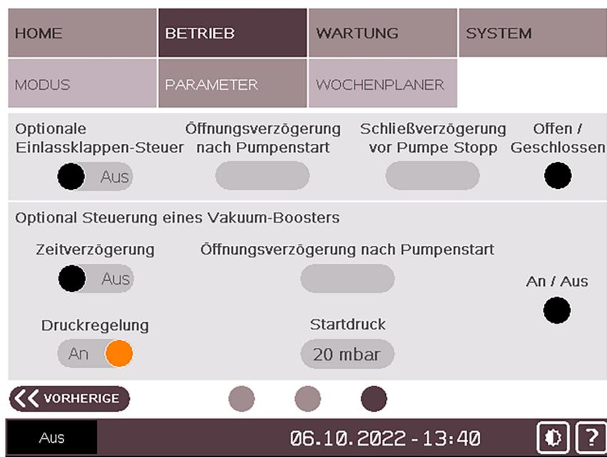
Das Startsignal für den Booster wird von der PLUS-Pumpe ausgegeben, wenn der Druck einen festgelegten Wert erreicht (Standardwert 20 mbar).
