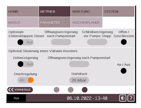
Das Startsignal für den Booster wird von der PLUS-Pumpe ausgegeben, wenn der Druck einen festgelegten Wert erreicht (Standardwert 20 mbar).
