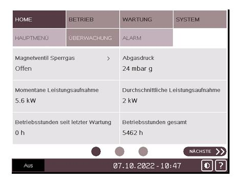
**Sperrgas-Magnetventil:** Gibt den Zustand des Sperrgas-Magnetventils wieder ▶ "Geöffnet" oder "Geschlossen".
