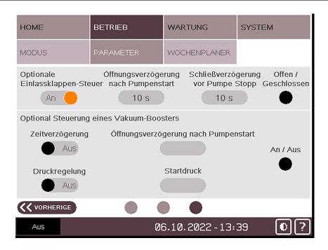
Das System ermöglicht eine Zeitverzögerung zwischen dem Öffnen des Ventils und dem Start der Vakuumpumpe (Standardwert 10 s).
