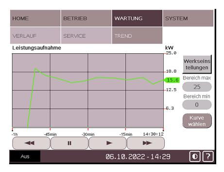
Die Zeitspanne und die Kurve der 5 unterschiedlichen Betriebswerte können einzeln oder gleichzeitig geändert werden.
