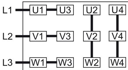
Collegamento a stella, motore multi-tensione con 12 pin (alta tensione):
