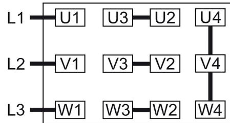
Collegamento a triangolo, motore multi-tensione con 12 pin (media tensione):
