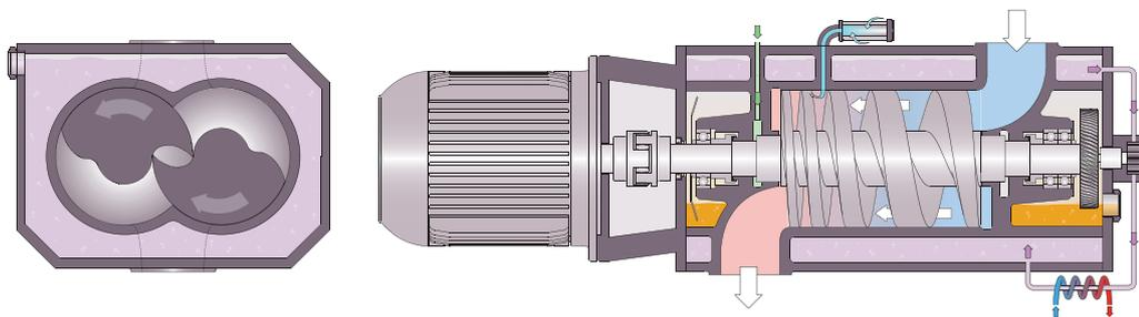
La macchina funziona in base al principio di pompaggio monostadio a doppia vite.
