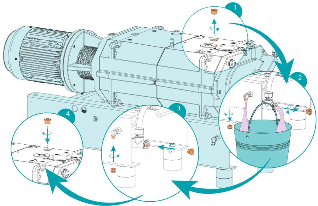
Per il tipo e la capacità del liquido di raffreddamento, vedere Dati tecnici e *Liquido di raffreddamento* [→ 48].
