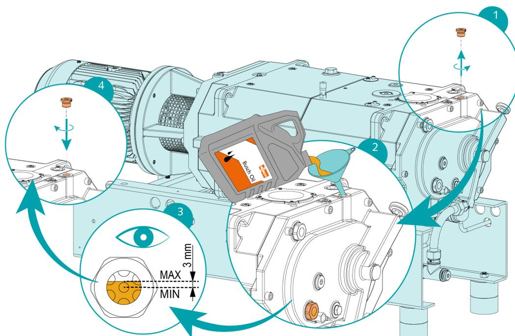
Una volta effettuato il rifornimento dell'olio:
