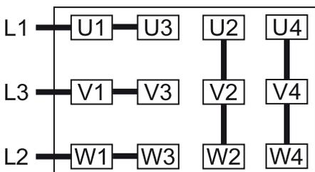
Collegamento a stella, motore a multitemperatura con 12 pin (alta tensione):
