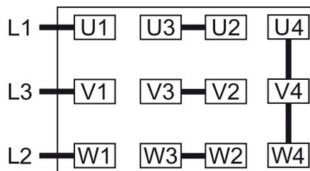
Collegamento a triangolo, motore a multitemperatura con 12 pin (media tensione):
