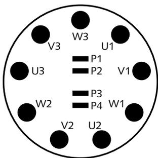
Anschluss von Motortemperaturschaltern (empfohlen):
